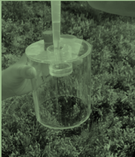
Et jordrespirometer er typisk en akrylcylinder med en diameter på 9,5 cm og med et reservoir til absorptionsvæske. Foto: Kim Bruun.
